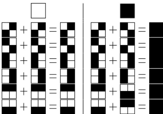
**Tableau de chiffrement.** Chaque pixel original est codé aléatoirement par deux ensembles de quatre pixels (deux blancs et deux noirs). Si les deux ensembles sont identiques, on a affaire à un pixel blanc. Si les deux ensembles sont complémentaires, il s'agit d'un pixel noir.
