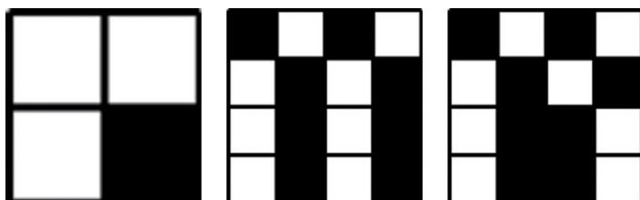
Lorsque la clé secrète est construite au préalable et partagée entre les correspondants, cela revient à fixer d'avance la ligne choisie dans le tableau de chiffrement, pour chaque pixel de l'image en clair. Le schéma de gauche est alors représenté sur la clé, tandis que l'un des deux schémas de droite sera reproduit sur l'image chiffrée au moment du chiffrement, en fonction de la couleur du pixel de l'image en clair.
