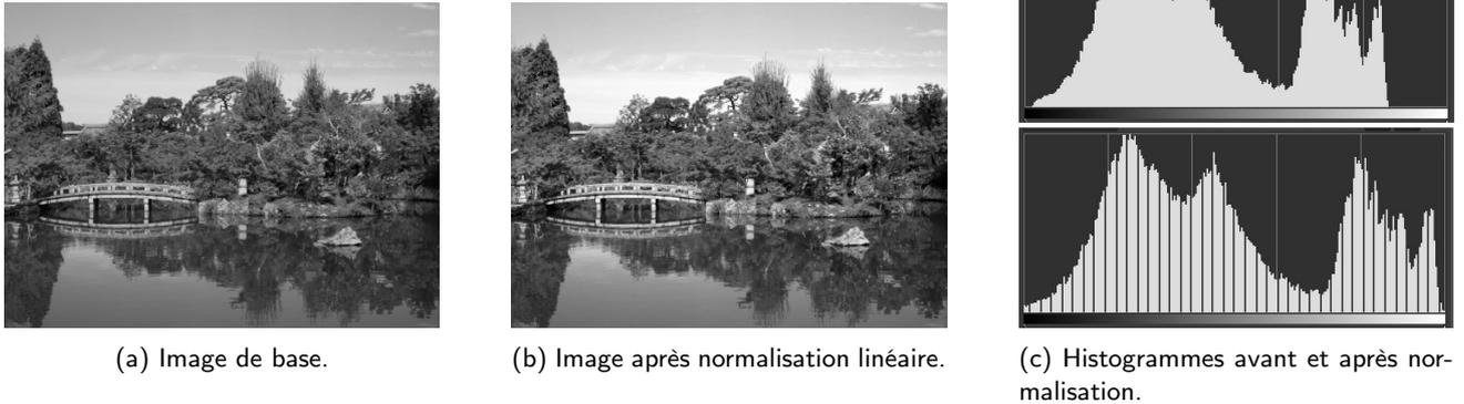
FIGURE 13 – Ajustement du contraste par normalisation d'histogramme.
